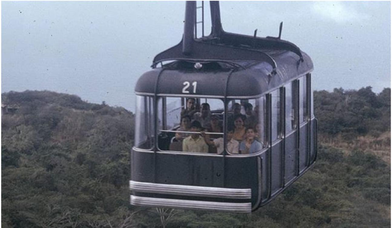
Las cabinas empleadas en el sistema teleférico Caracas - Litoral (1955 / 1956) fueron diseñados por la firma Ernest Heckel y tenían capacidad para 24 personas sentadas.
